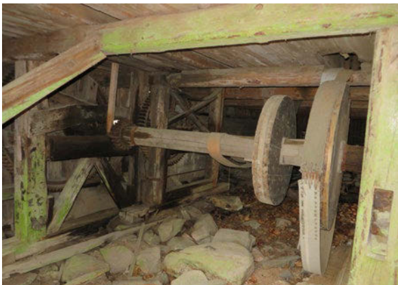
Kvarnhjulet finns kvar, men axeln är dessvärre avbruten.
